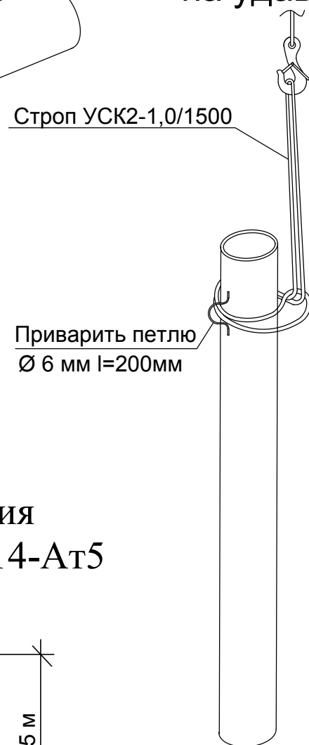
Схема строповки металлической трубы на удавку
