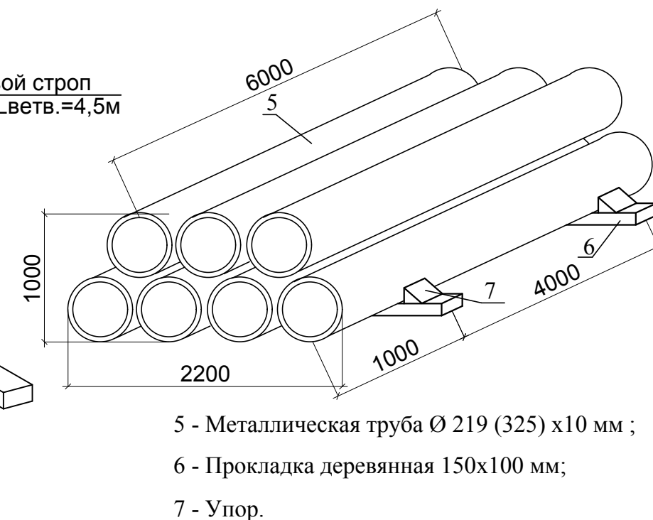
Схема складирования металлических труб
